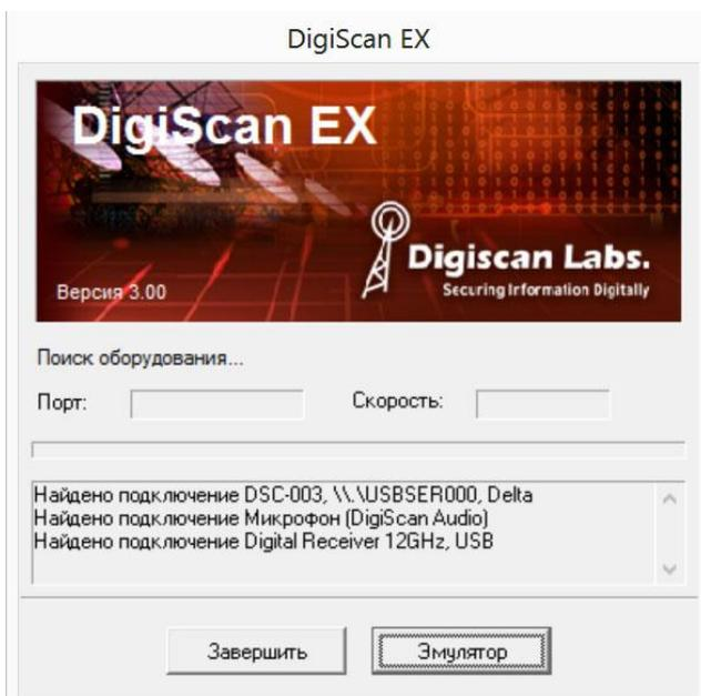
Во время запуска должны быть обнаружены 3 компонента: контроллер DSC-003, аудио устройство "DigiScan Audio" и приемник «Digital Receiver». Программное обеспечение будет работать в демонстрационном (эмуляторном) режиме, если DSC-003 или приемник не будет найден. В этом случае необходимо закрыть программное обеспечение и проверить, все ли драйверы были установлены правильно.
