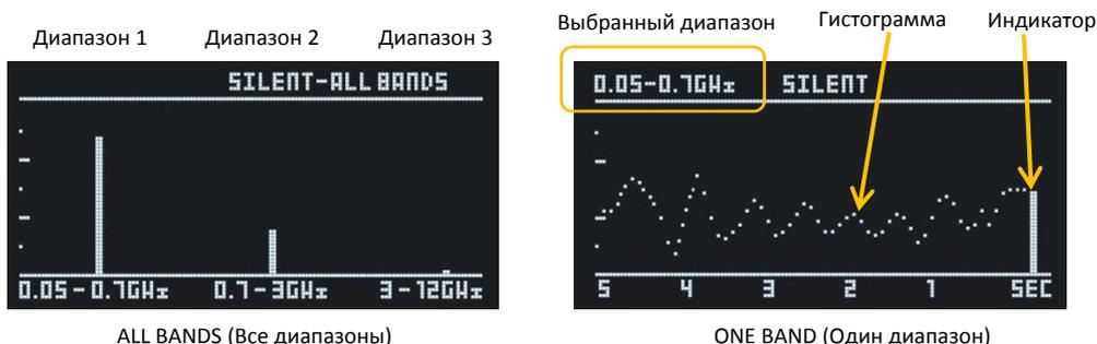
**AUDIO** (Звуковой) – прибор создает звуковой след сигнала. Некоторые сигналы имеют типичный звук, например, Wi-Fi или мобильное устройство GSM/3G/LTE, поэтому в некоторых случаях пользователь может распознать протокол сигнала.
